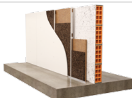
METALSTOLPER PÅ MURET VÆG MED CORKOCO ISOLERING
