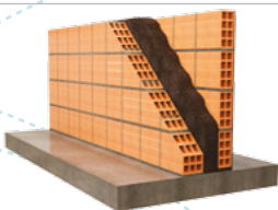
DOBBELT INDENDØRS VÆG MED FYLD AF KORKGRANULAT
