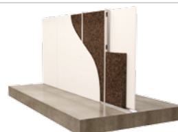
METALSTOLPE SKILLEVÆG MED KORKISOLERING
