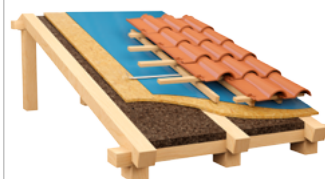
SKRÅTAG MED UNDERLIGGENDE ISOLERING MELLE M SPÆR
