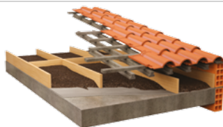
SKRÅTAG MED LØSFYLD/ GRANULAT MELLE M LOFTSBJÆLKER
