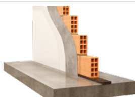
MURET VÆG VED AFBRUDT GULVPLADE
